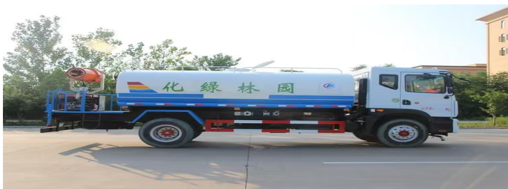
图 4-6 4 辆 14 吨东风 D9 雾炮洒水车
