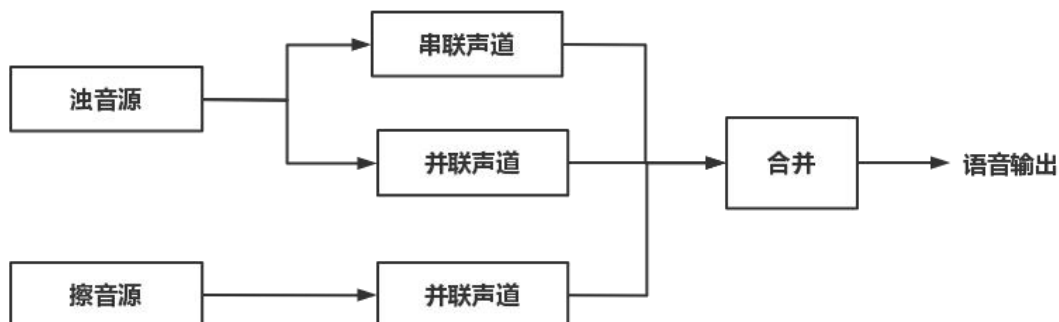
图2.1 Klatt共振峰合成器结构模型
