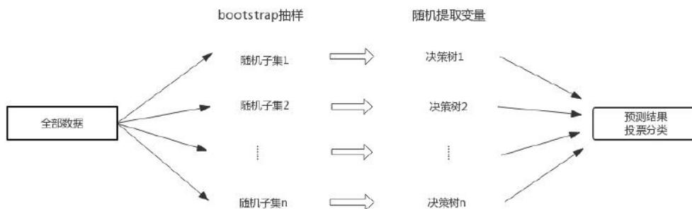
图 2.1 随机森林机器学习计算原理图<sup>1</sup>
